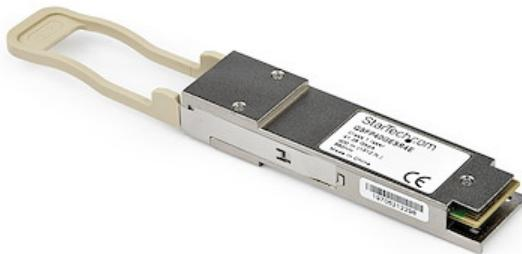
Il JG325B-ST è un modulo ricetrasmettitore QSFP in fibra compatibile con HPE JG325B progettato, programmato e testato per funzionare con switch e router prodotti da HPE®. Offre una connettività affidabile 40 GbE su cavo in fibra per le reti compatibili con 40GBASE-SR4 a una distanza massima di 150 m.
