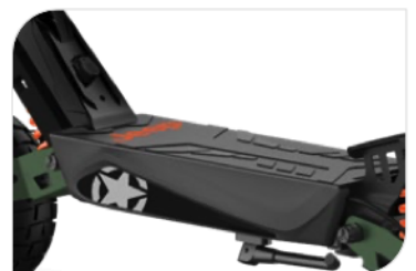
Batteria 48 V, 15 Ah, 720 Wh con BMS smart
