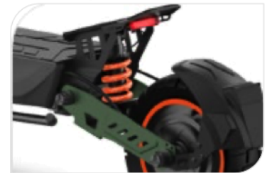
Sospensioni anteriori e posteriori con mono ammortizzatore centrale
