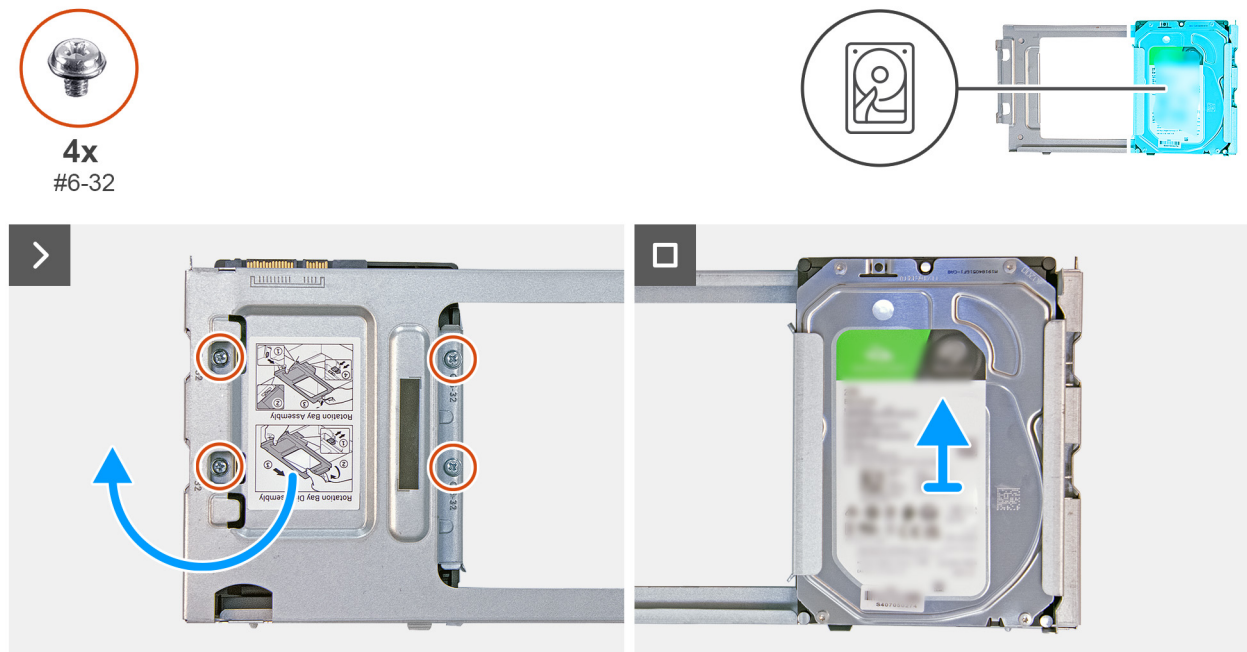
Figura 33. Rimozione del disco rigido.
