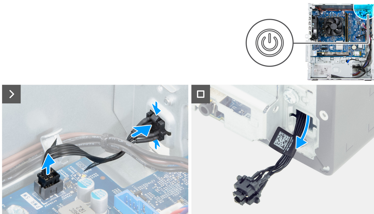
Figura 35. Rimozione del pulsante di accensione
