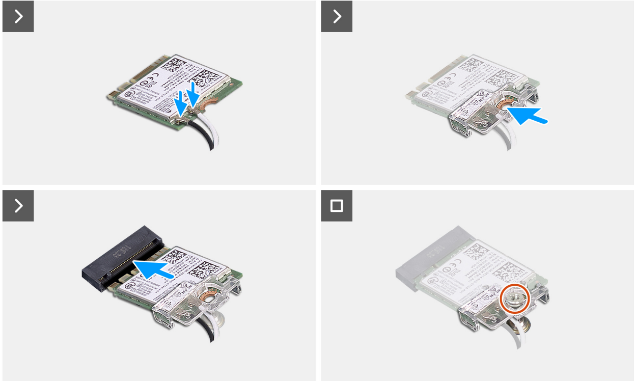
Figura 27. Installazione della scheda wireless
