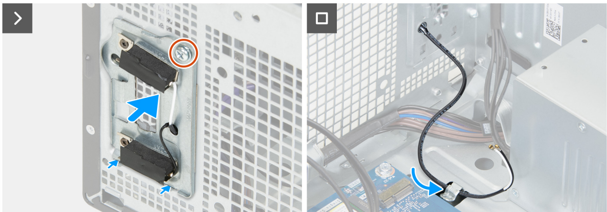
Figura 45. Installazione dei moduli dell'antenna
