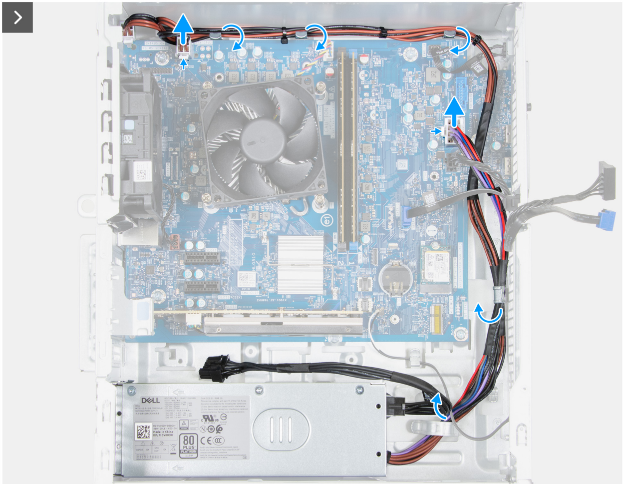
Figura 46. Rimozione dell'unità di alimentazione
