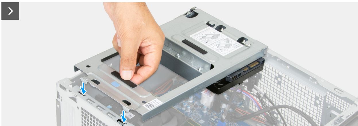
Figura 31. Installazione del drive bay
