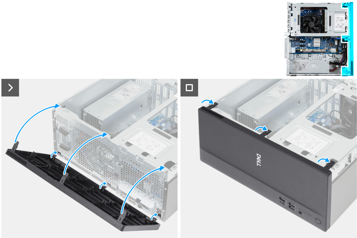
Figura 19. Installazione del coperchio anteriore
