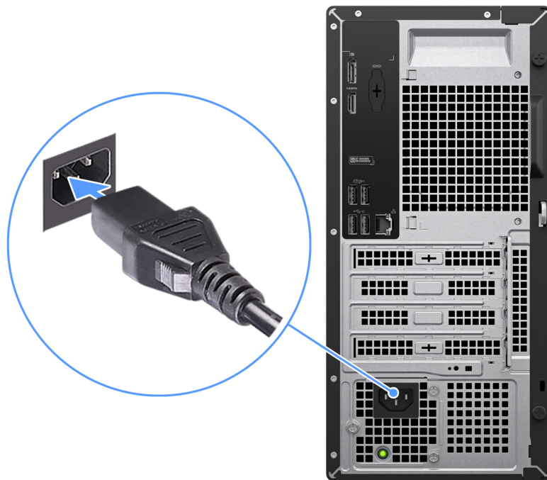
Figura 7. Collegamento del cavo di alimentazione
