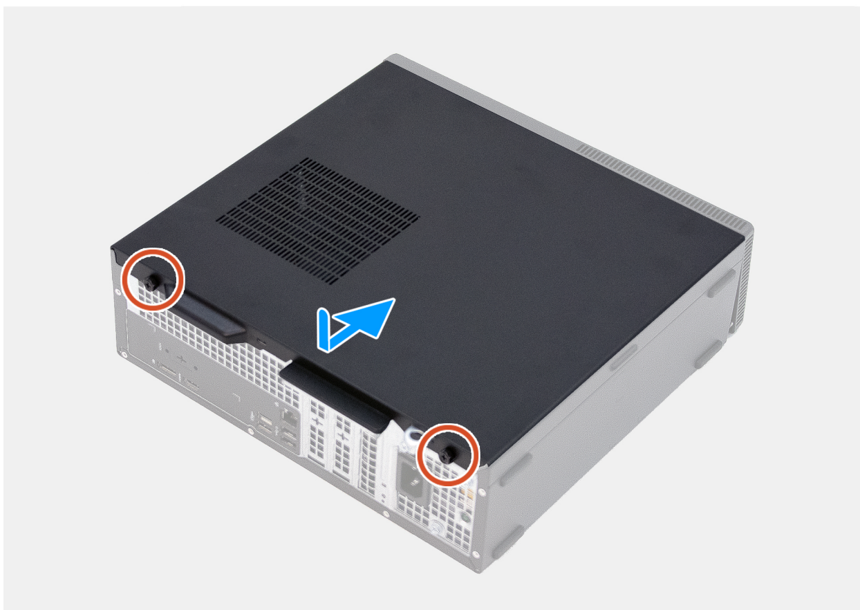
Figura 11. Installazione del pannello laterale sinistro
