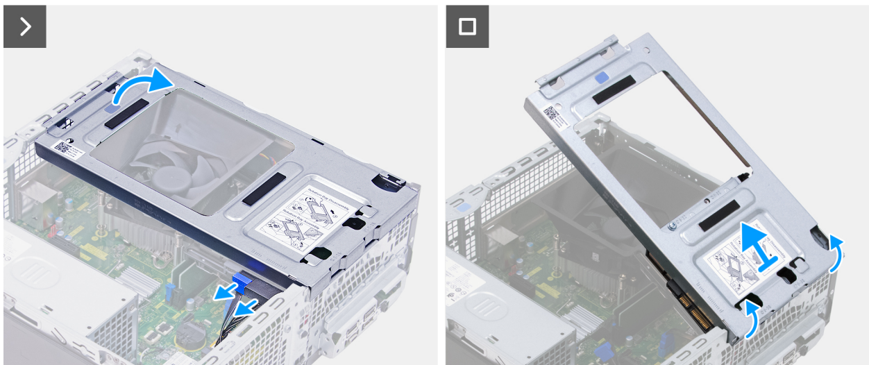
Figura 18. Rimozione del drive bay
