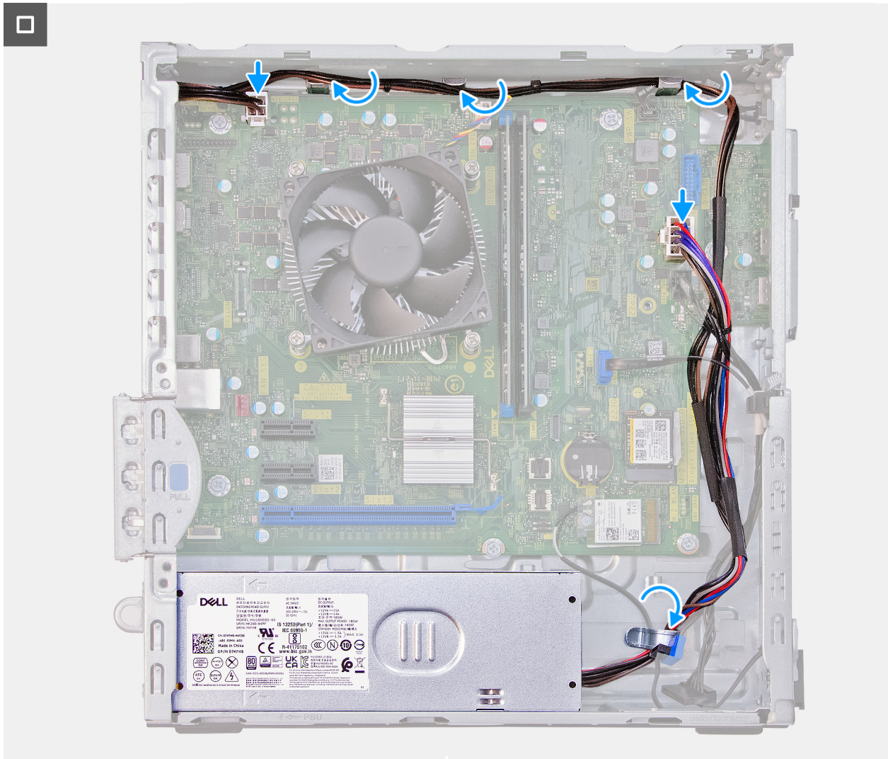
Figura 36. Installazione dell'unità di alimentazione
