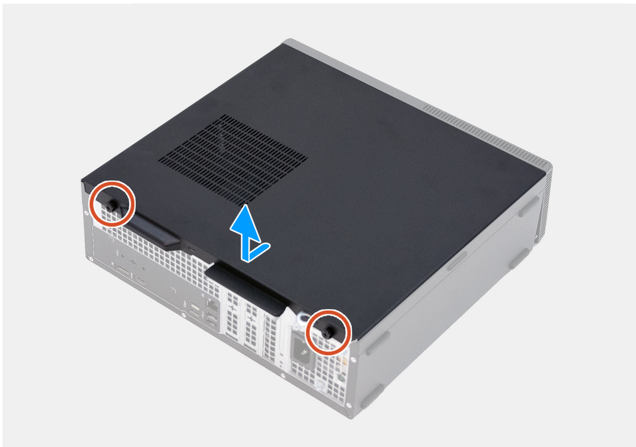
Figura 10. Rimozione del pannello laterale sinistro
