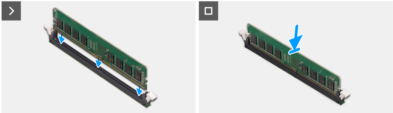
Figura 24. Installazione del modulo di memoria
