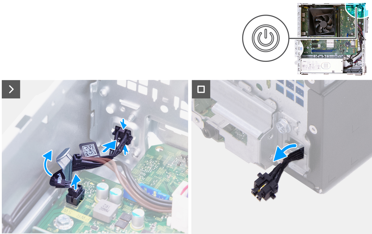
Figura 43. Rimozione del pulsante di accensione
