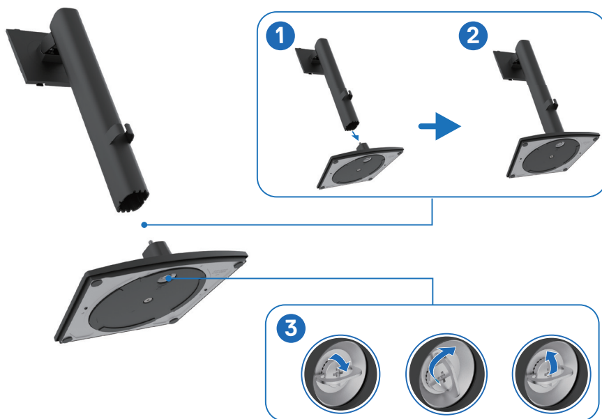
Figura 15. Collegamento della base
