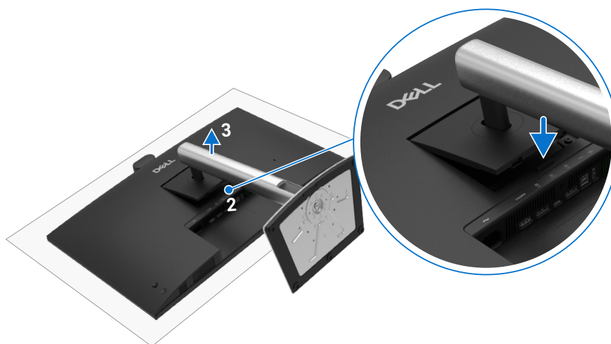
Figura 60. Rimuovere il supporto del monitor
