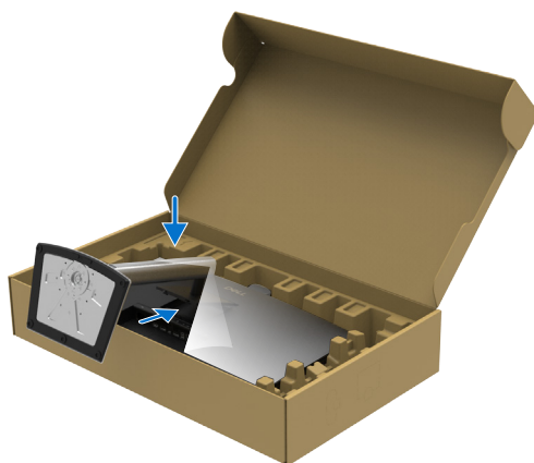
Figura 22. Inserire le linguette sul montante nelle fessure
