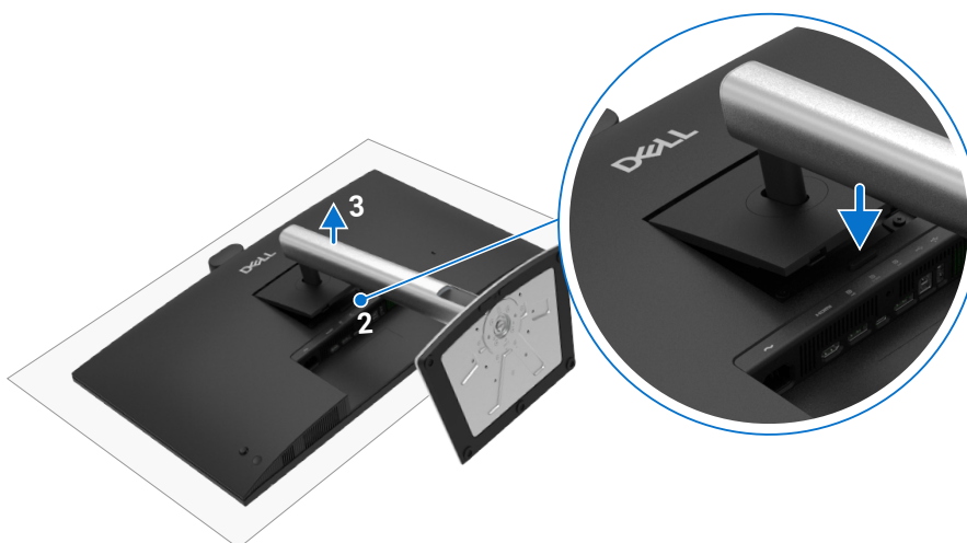
Figura 60. Rimuovere il supporto del monitor
