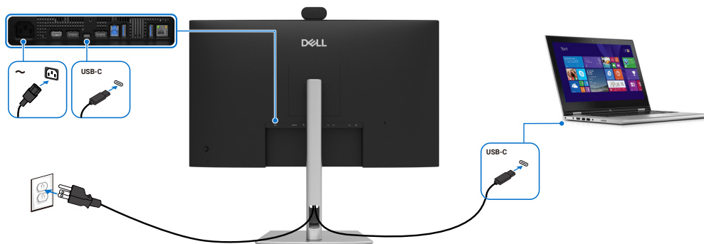
Figura 39. Collegamento del cavo USB-C
