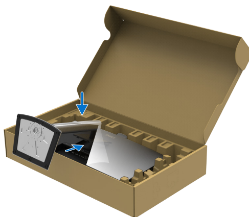
Figura 22. Inserire le linguette sul montante nelle fessure
