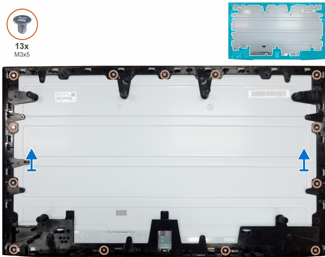
Figura 20. Rimozione del telaio centrale
