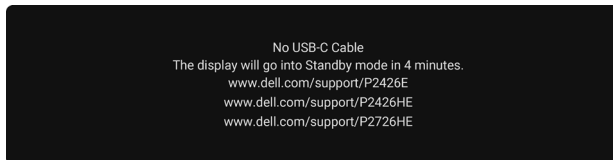
Figura 80. Messaggio di avviso sul cavo USB-C scollegato
