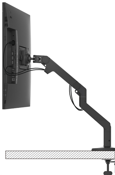
Figura 57. Collegare i cavi nella posizione più alta e con la massima rotazione
