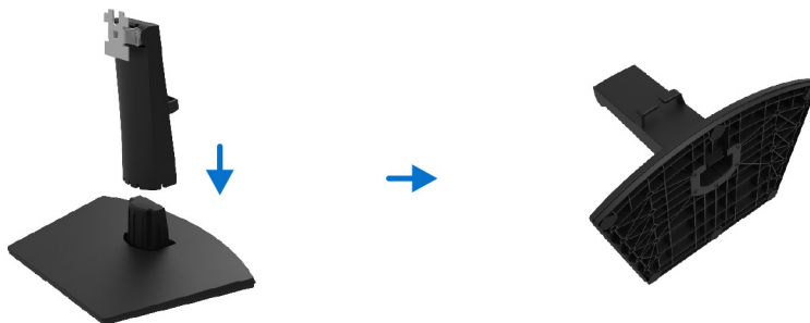
Figura 10. Assemblaggio della base
