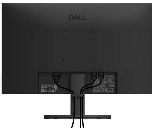
Figura 16. Organizzazione dei cavi
