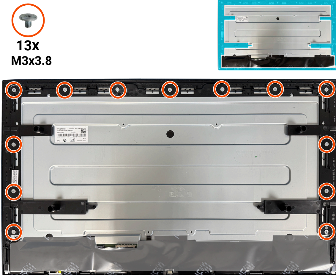
Figura 29. Installazione della struttura centrale
