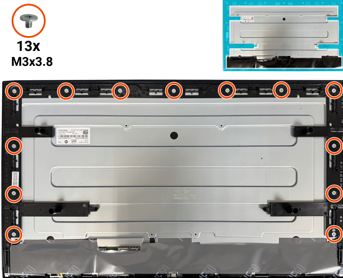
Figura 28. Rimozione della struttura centrale
