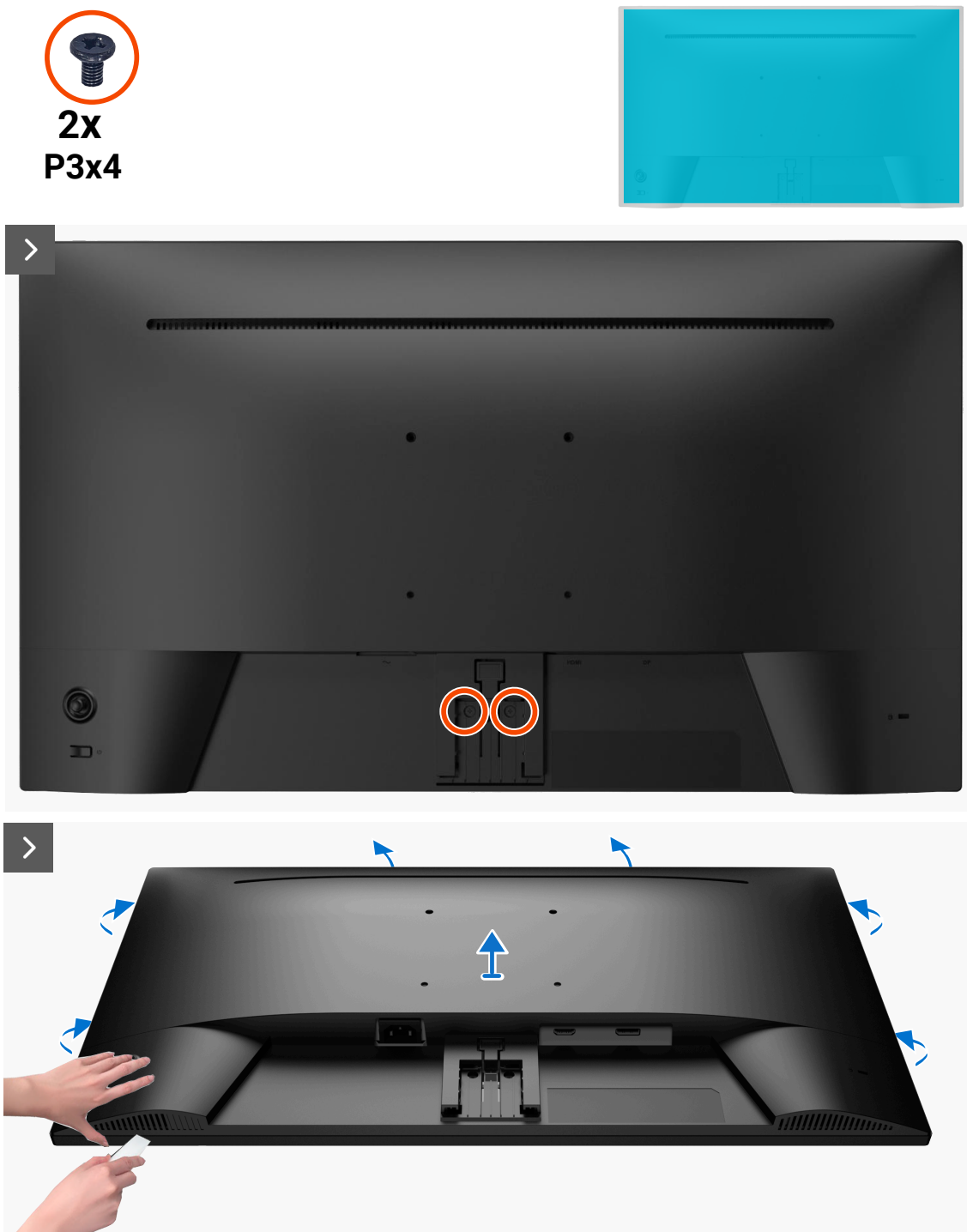
Figura 14. Rimozione del coperchio posteriore
