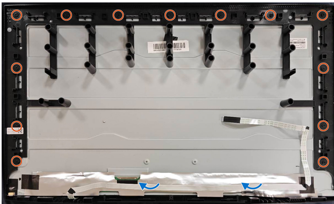
Figura 18. Rimozione della struttura centrale
