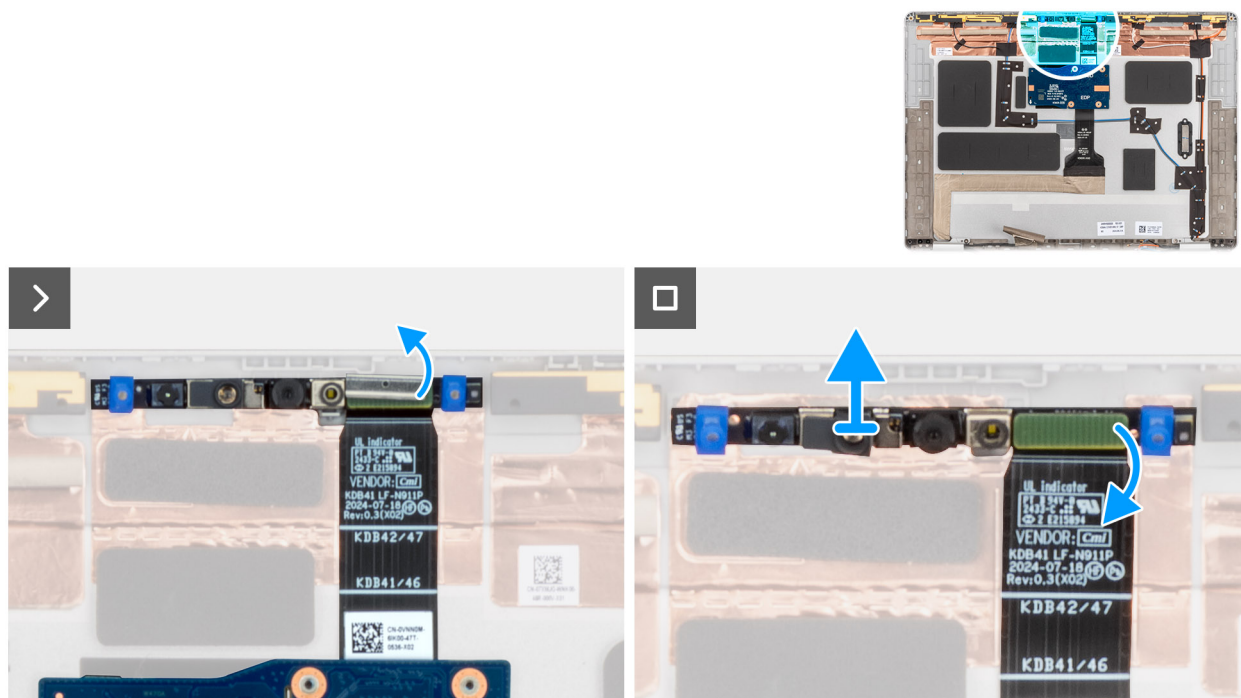
Figura 88. Rimozione della fotocamera MIPI
