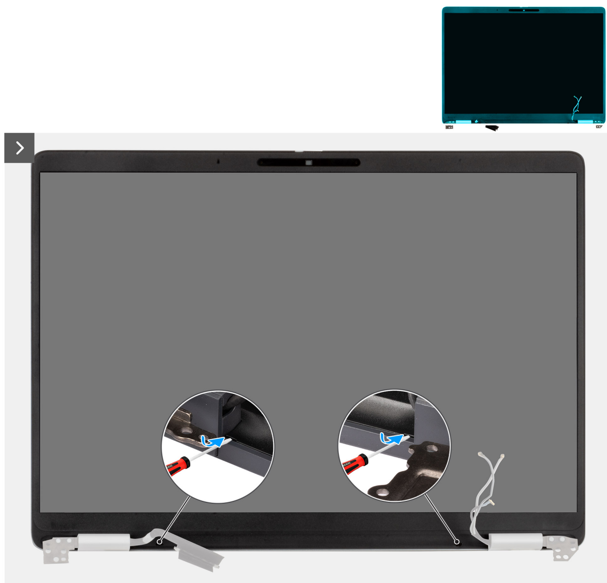
Figura 68. Rimozione della cornice del display
