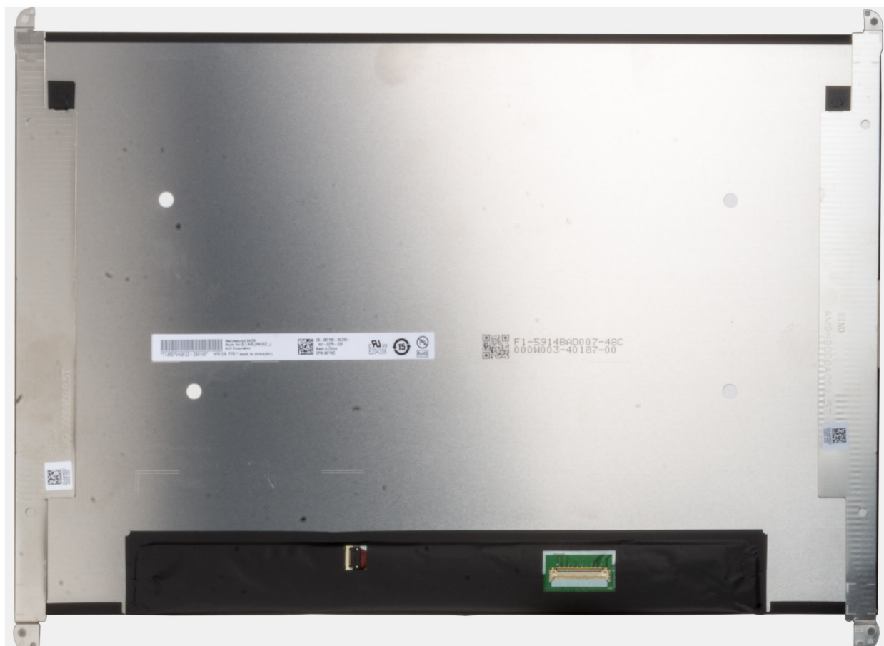
Figura 77. Pannello del display con staffe
