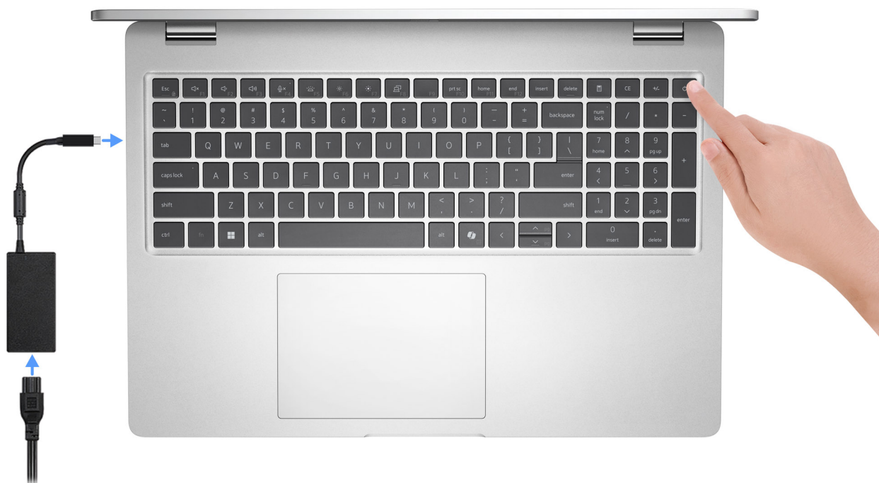
Figura 12. Collegare l'adattatore per l'alimentazione e premere il pulsante di accensione.
