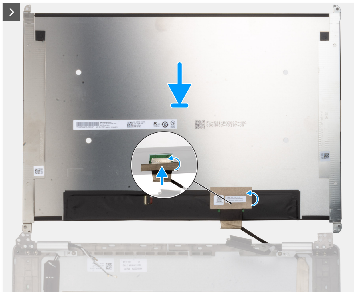
Figura 78. Installazione del pannello del display
