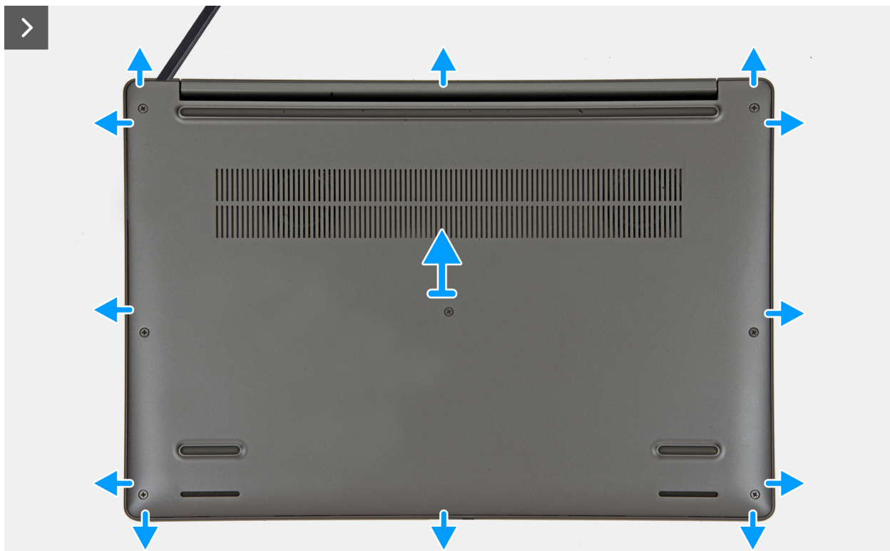
Figura 17. Rimozione del coperchio della base
