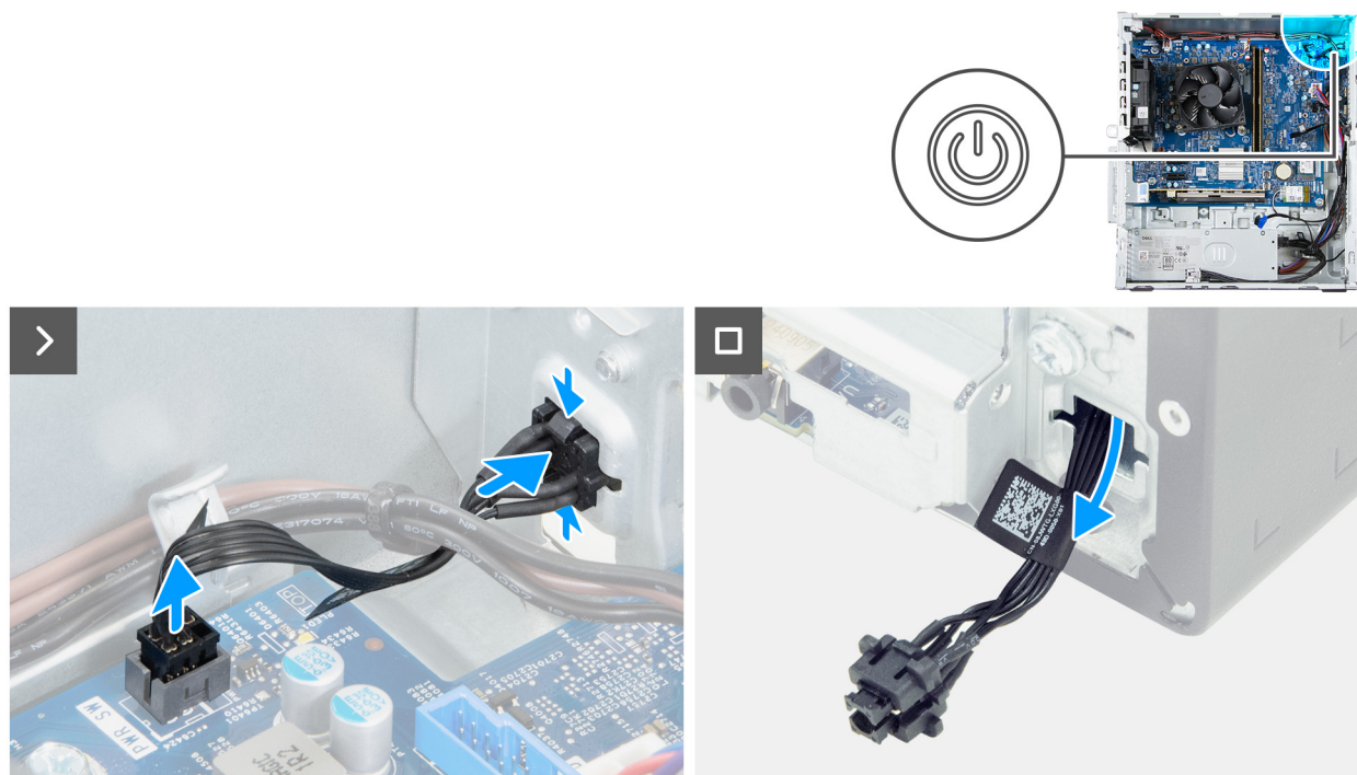
Figura 35. Rimozione del pulsante di accensione
