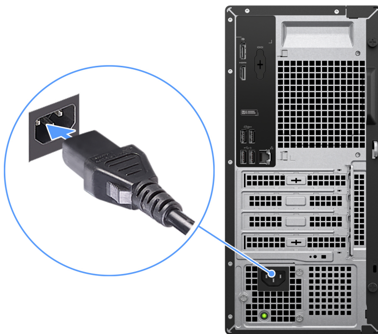
Figura 7. Collegamento del cavo di alimentazione
