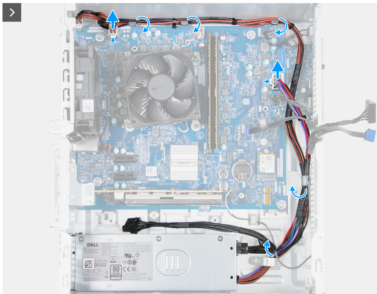
Figura 46. Rimozione dell'unità di alimentazione
