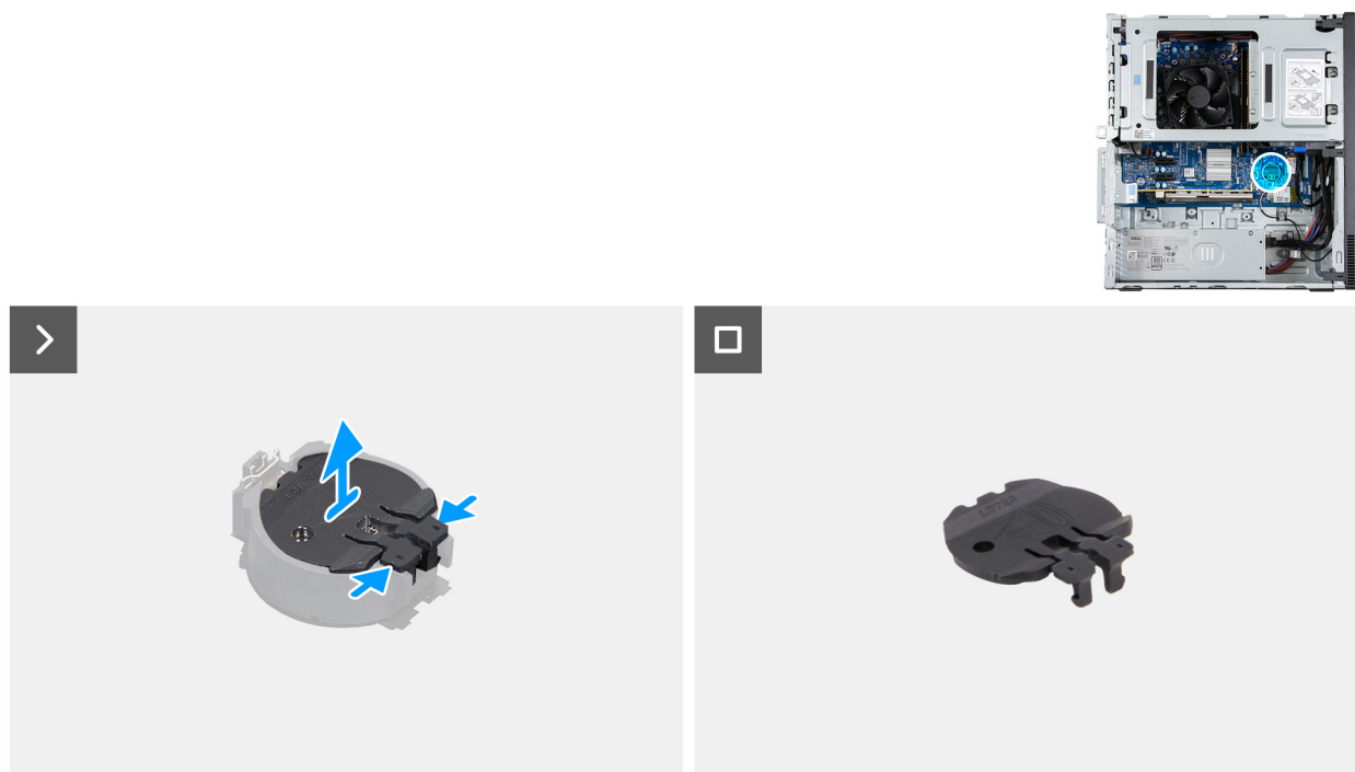
Figura 14. Rimozione del coperchio della batteria a bottone
