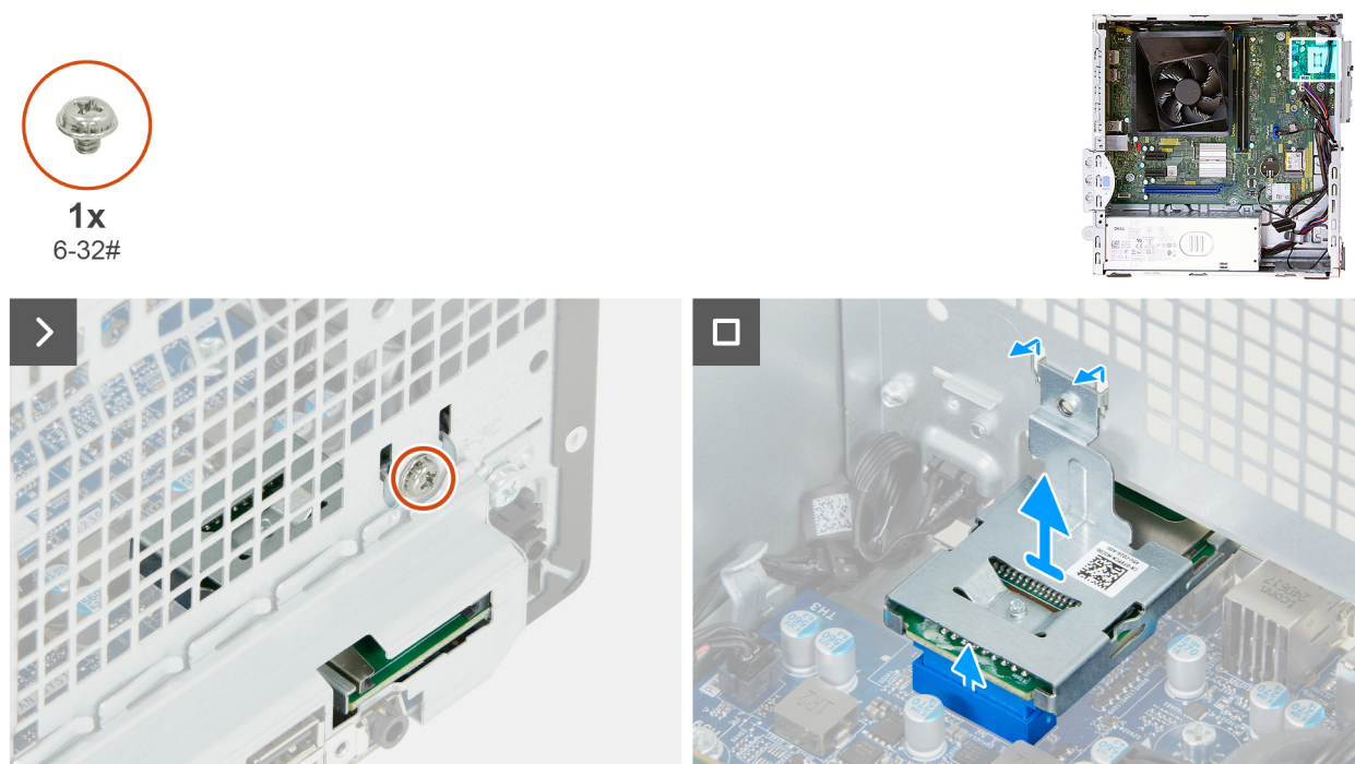
Figura 29. Rimozione del lettore di schede multimediali
