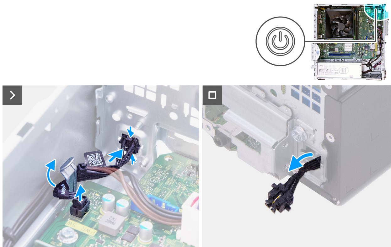
Figura 43. Rimozione del pulsante di accensione
