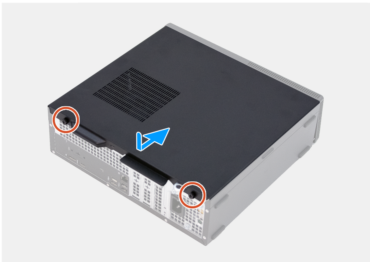
Figura 11. Installazione del pannello laterale sinistro
