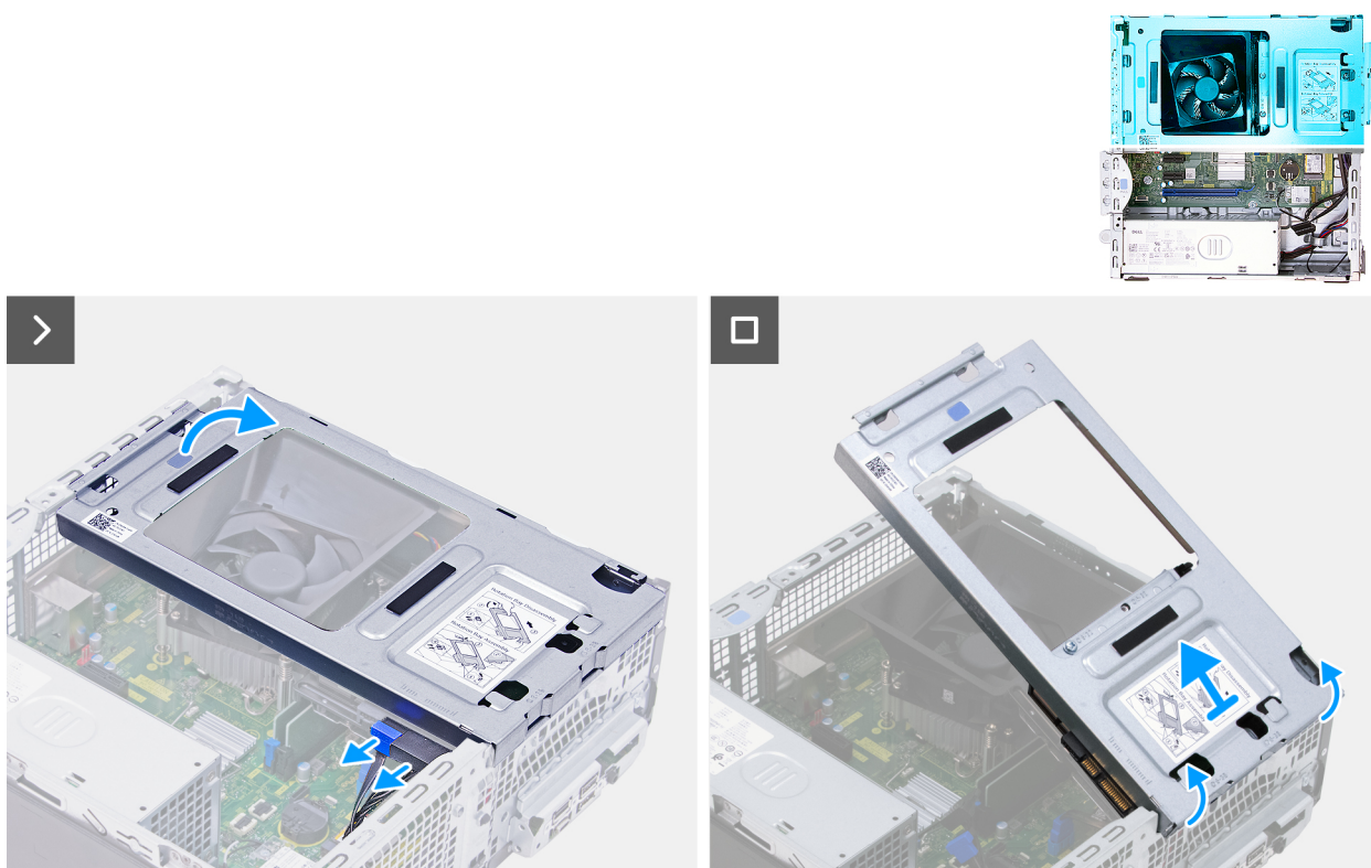
Figura 18. Rimozione del drive bay
