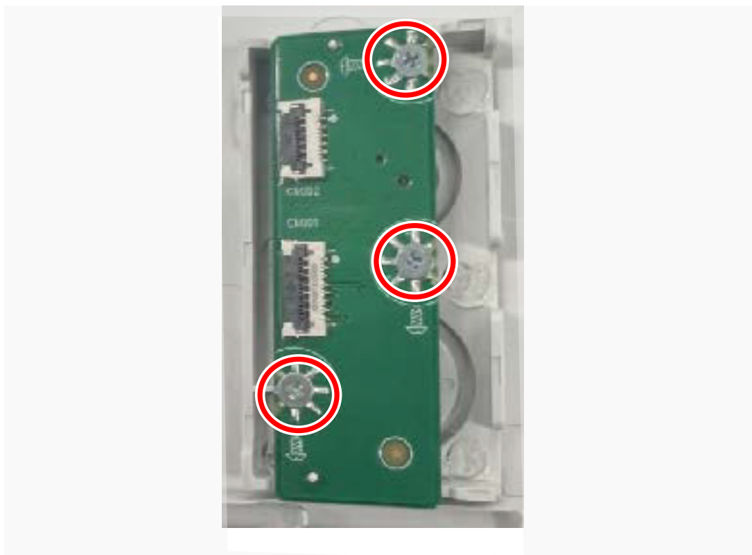
Figura 42. Installazione della scheda del tastierino
