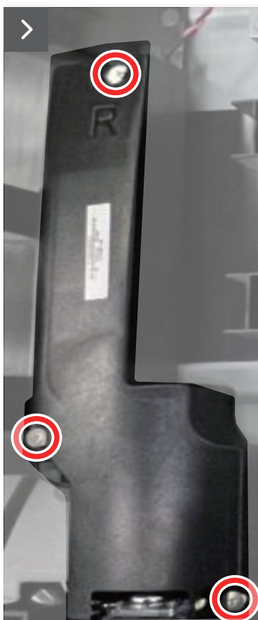
Figura 21. Collegamento del cavo altoparlante e installazione delle viti
