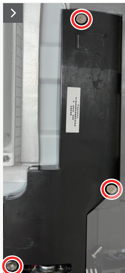
Figura 21. Collegamento del cavo altoparlante e installazione delle viti
