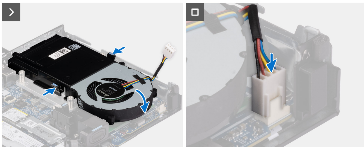
Figura 25. Installazione della ventola
