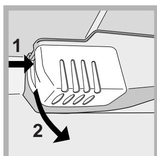
Acceda a la lámpara quitando la protección como se indica en la figura. Sustítúyala con otra bombilla con una potencia igual a la indicada en la protección (15 W o 25 W).
