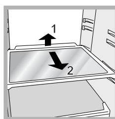
**DRAAGPLATEAU**: plateaus of roosters. Deze kunnen dankzij de speciale gleuven worden verwijderd of in hoogte geregeld (zie afbeelding), voor het invoeren van grote verpakkingen of etenswaren. Het is niet noodzakelijk het draagplateau volledig te verwijderen om de hoogte te regelen.
