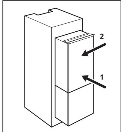
4. Spingere l'apparecchiatura nel senso delle frecce (2) contro il mobile sul lato opposto della cerniera.
