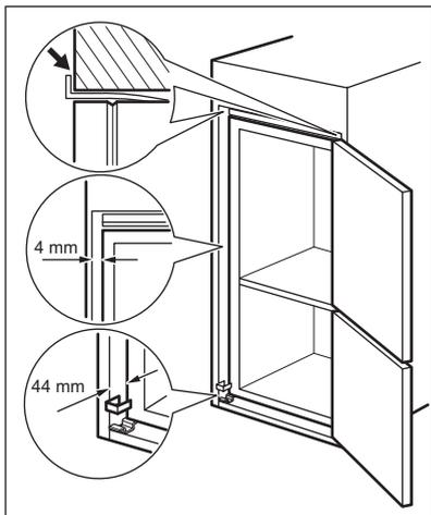
7. Fissare l'apparecchiatura nella nicchia con 4 viti.
