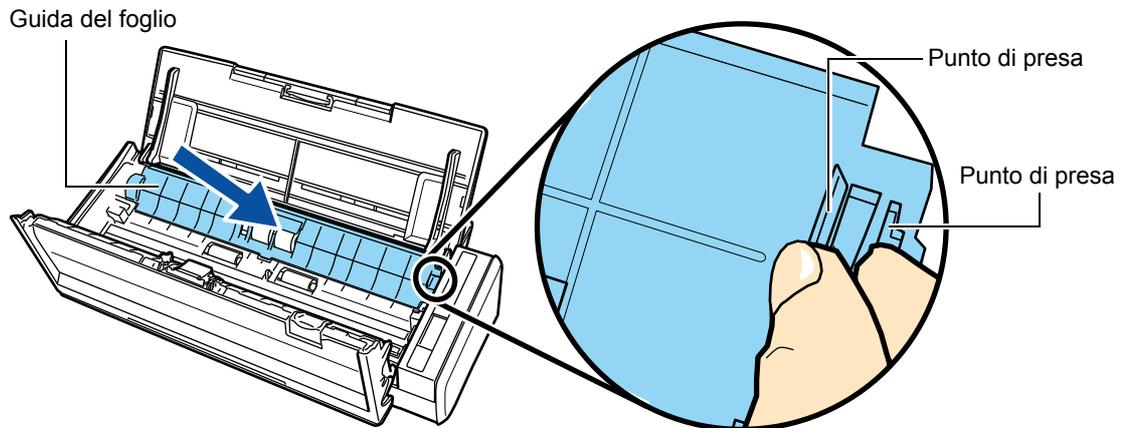
⇒ Una volta rilasciati i punti di presa, si incastra.
