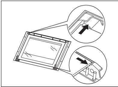
Al termine della pulizia, rimontare il pannello di vetro e la porta del forno. Eseguire la procedura illustrata in precedenza, seguendo la sequenza inversa. Accertarsi che la serigrafia sia sul lato interno della porta. Verificare che dopo l'installazione, la superficie della cornice del pannello di vetro, nei punti delle serigrafie, non risulti ruvida al tatto. Accertarsi di installare il pannello di vetro interno nelle sedi corrette. Fare riferimento all'immagine.
