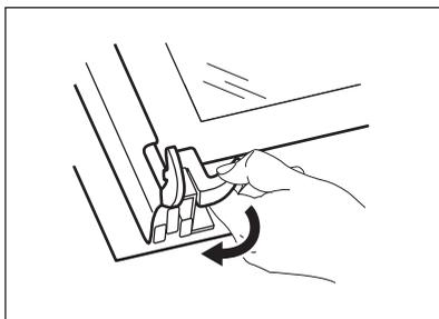
5. Sganciare il sistema di bloccaggio per rimuovere il pannello di vetro interno.
