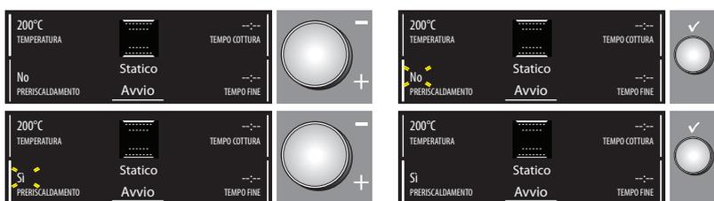
Qualora si volesse preriscaldare il forno prima di inserire la pietanza da cuocere, è necessario modificare la preselezione del forno come segue:
