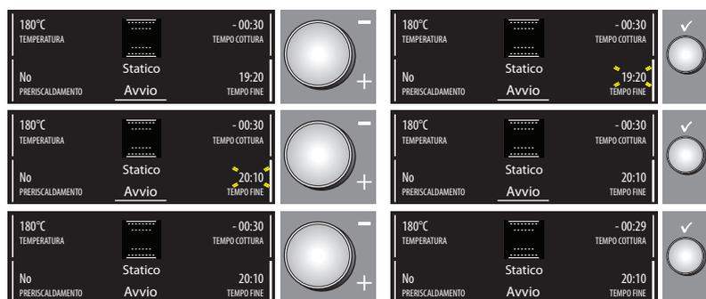
Dopo aver impostato la durata della cottura, sul display viene visualizzata l'ora di fine cottura (ad esempio 19:20). Per ritardare la fine della cottura, posticipando l'avvio del forno, procedere come segue:
