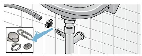
4. Collegare il tubo di scarico nel raccordo di scarico e serrare la fascetta stringitubo.
