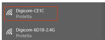
**! NOTA: L'SSID è composto da 'Digicom-' seguito dalle ultime 4 cifre del MAC Address, ad esempio Digicom-CE1C. L'SSID di fabbrica, come anche il MAC Address, sono riportati sull'etichetta presente sul lato inferiore del prodotto.**
