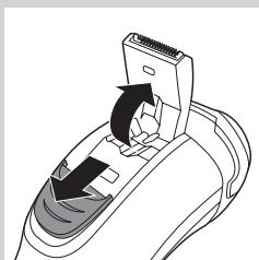
**3** Una vez finalizado el corte, cierre el cortapatillas y apague la afeitadora.
