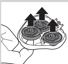
**5** Entnehmen Sie einen Scherkopf, und reinigen Sie ihn. Jeder Scherkopf besteht aus einem Schermesser und einem Scherkorb.
