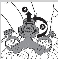
**4** Drehen Sie die Verriegelung gegen den Uhrzeigersinn (A), und entnehmen Sie den Scherkopfhalter (B).
