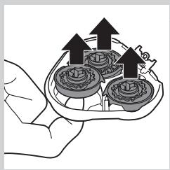
**5** Rimovete e pulite una testina di rasatura alla volta. Ogni testina di rasatura è composta da una lama e un paralama.
