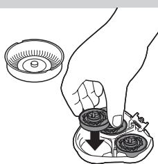
**6** Αφαιρέστε τις ξυριστικές κεφαλές και τοποθετήστε καινούριες κεφαλές στη μονάδα ξυρίσματος.
