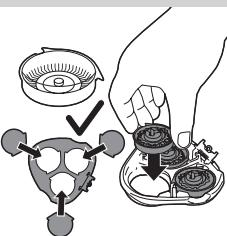
*Nota: Asegúrese de que los salientes de los cabezales de afeitado encajan exactamente en las ranuras.*
