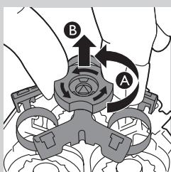
**5** Faites tourner le système de fixation dans le sens inverse des aiguilles d'une montre (A), puis retirez-le (B).
