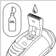
*Consiglio: Per ottenere prestazioni ottimali, lubrificate i dentini del rifinitore ogni sei mesi, utilizzando una goccia di olio per macchina da cucire.*
