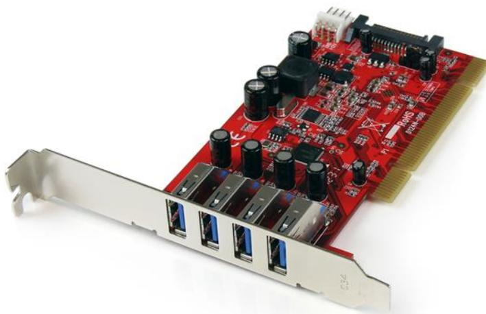
La scheda PCI a USB 3.0 4 porte PCIUSB3S4 permette agli slot PCI di vecchia generazione di supportare lo standard USB 3.0 SuperSpeed, con velocità di trasferimento dei dati fino a 5 Gbps. Utilizzando dispositivi USB 3.0 con questa scheda è possibile aumentare la velocità di trasferimento dei dati fino a 1,3 Gbps di larghezza di banda disponibile (limite bus PCI) raddoppiando così le prestazioni rispetto a una connessione USB 2.0.
