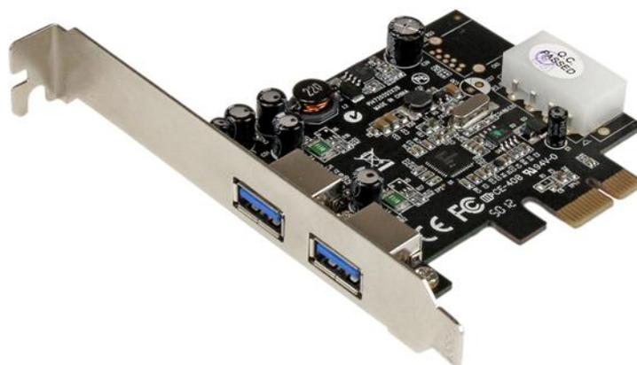
La scheda PCI Express USB 3.0 a 2 porte PEXUSB3S25 consente di aggiungere due porte USB 3.0 a qualsiasi computer dotato di PCI Express con un connettore di alimentazione LP4 opzionale per il collegamento dell'alimentazione del sistema e fino a 900 mA di alimentazione per porta a dispositivi alimentati tramite bus USB 3.0 (500 mA per USB 2.0).
