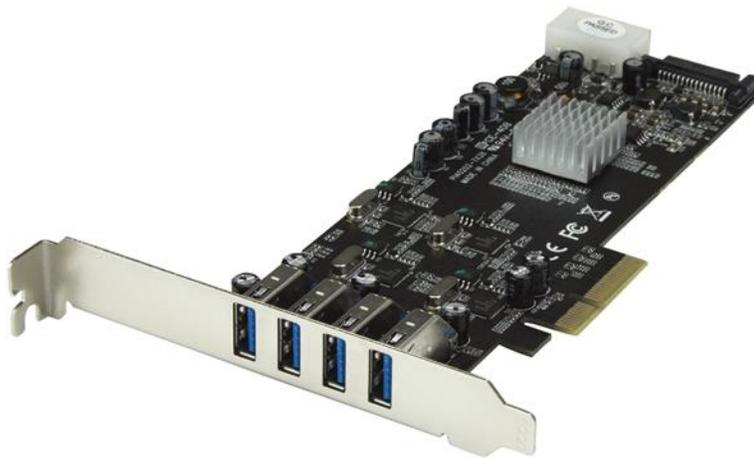
La scheda USB 3.0 PCI Express a 4 porte PEXUSB3S44V permette di aggiungere quattro porte USB 3.0 da 5 Gbps dedicate a un PC dotato di 4 PCIe. L'architettura a porte indipendenti migliora le prestazioni USB 3.0 trasferendo i dati al computer tramite quattro canali separati, aumentando al contempo la velocità di trasferimento dei file.
