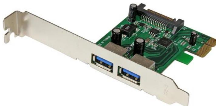
La scheda PCI Express USB 3.0 a 2 porte PEXUSB3S24 consente di aggiungere due porte USB 3.0 a qualsiasi computer dotato di PCI Express con un connettore di alimentazione SATA opzionale per il collegamento dell'alimentazione del sistema e fino a 900 mA di alimentazione per porta a dispositivi alimentati tramite bus USB 3.0 (500 mA per USB 2.0).
