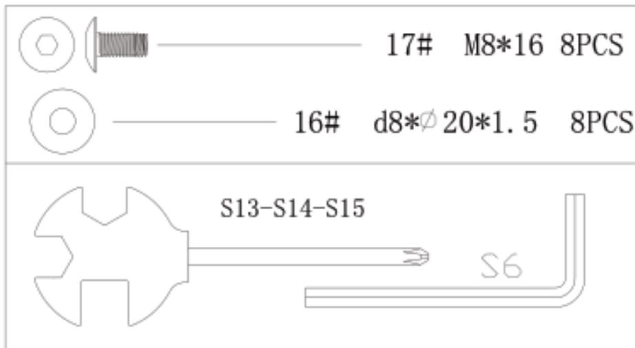
a) Assemblare il piede anteriore (22) e il piede posteriore (24) al telaio base (48) e fissarlo con bulloni (17) e rondelle (16).
