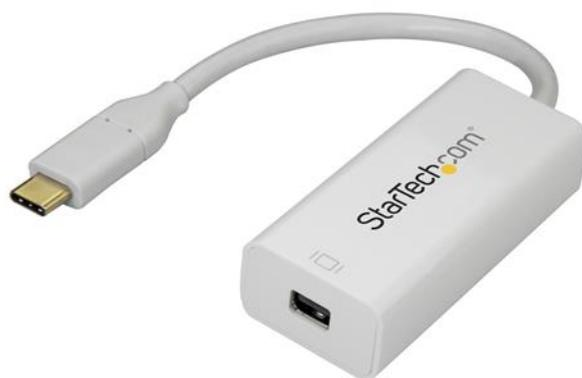
Questo adattatore USB-C™ a Mini DisplayPort consente di trasmettere audio e video mDP dalla porta USB Type-C™ del computer laptop o di un altro dispositivo. L'adattatore funziona con i dispositivi USB-C che trasmettono un segnale video DisplayPort (DisplayPort Alternate Mode), ad esempio un MacBook Pro, Chromebook™ o altri computer laptop USB-C.
