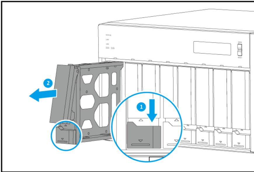
3. Installare una unità nel vano unità.
