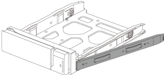
**b.** Posizionare l'unità sul vassoio in modo che i fori sui lati dell'unità siano allineati coi fori sulla base del vassoio.
