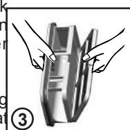
4. Verwijder voorzichtig de spons van zijn plaats en was hem daarna door hem onder een stromende kraan te houden en hem zo te draaien dat alle stof of pluizen verwijderd worden
