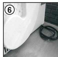
Den schwarzen Ablaufschlauch an das Abwasserrohrsystem anschließen.
