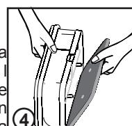
5. Vuelva a colocar la cubierta frontal asegurándose que se encuentra en la posición correcta (la indicada por la flecha) y empuje firmemente en su lugar. Bloquee las dos palancas en sentido horario.
