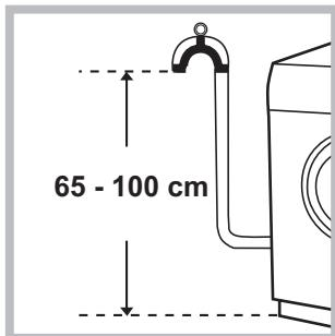
Conecte el tubo de descarga, sin plegarlo, a una tubería de descarga o a una descarga de pared colocadas a una altura del piso entre 65 y 100 cm;
