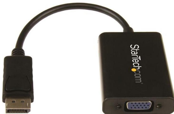
Questo unico adattatore DisplayPort™ a VGA è dotato di una porta audio integrata che consente di collegare dispositivi dotati di DisplayPort quali, ad esempio, laptop HP® EliteBook Folio 9470m a un display o proiettore VGA con audio.
