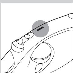
La función de desconexión automática de seguridad apaga automáticamente la plancha si no se utiliza durante 30 segundos mientras está sobre la base de apoyo o la suela o durante 8 minutos sobre su placa posterior. El piloto de desconexión automática se iluminará.
